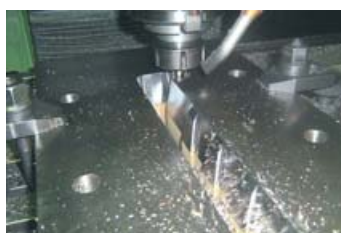
Рисунок 4. Изготовление детали фильеры по 3D-модели на станке с ЧПУ
